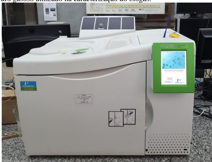
Figura 7 – Cromatógrafo gasoso utilizado na caracterização do biogás.
