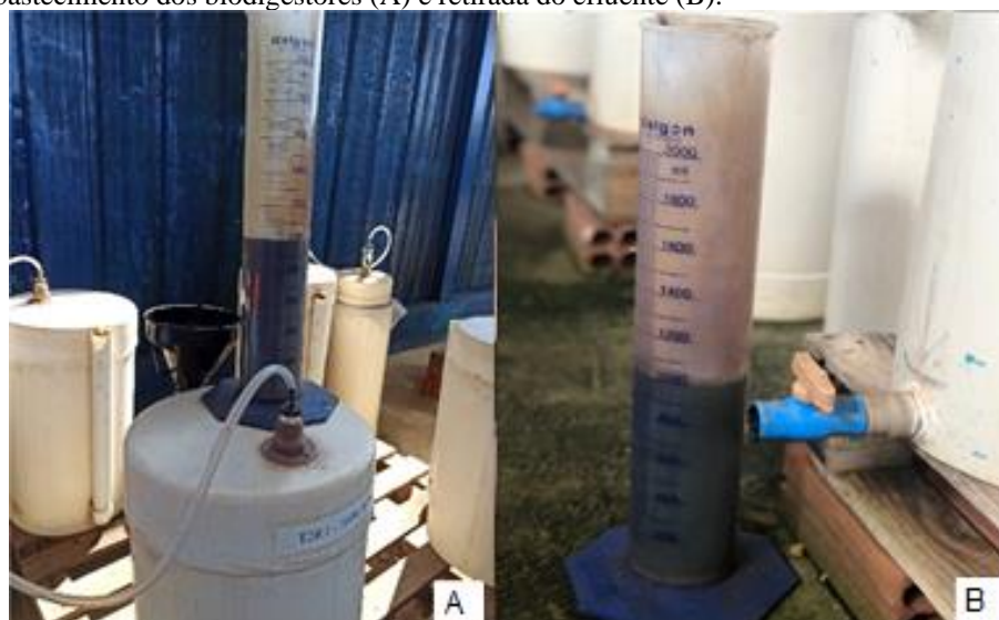
Figura 5 – Abastecimento dos biodigestores (A) e retirada do efluente (B).
