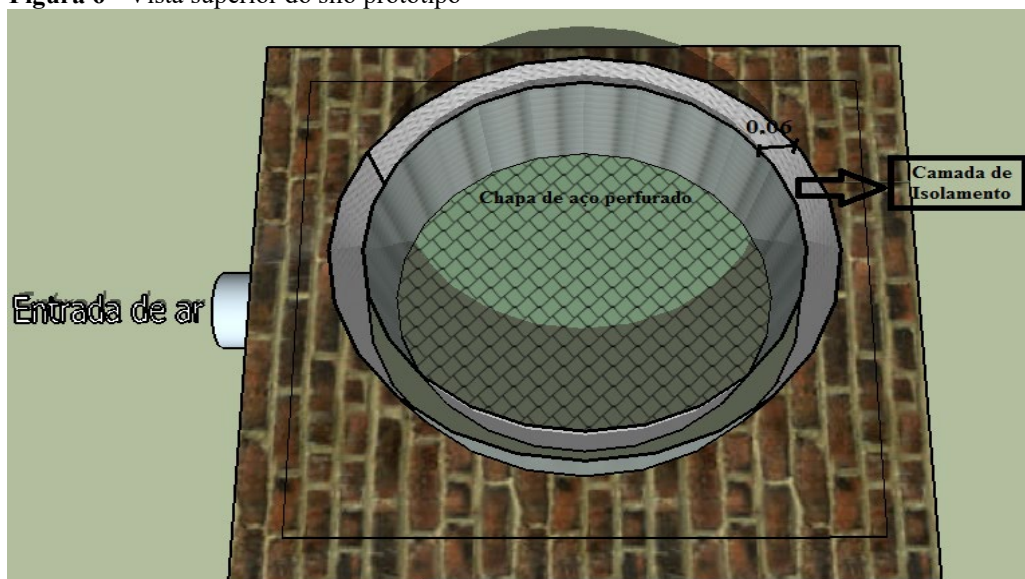
Figura 6 - Vista superior do silo protótipo
