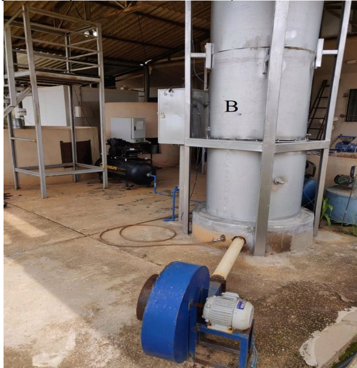
Figura 9 - Silo protótipo utilizado para avaliar o sistema de aeração artificialmente resfriado B
