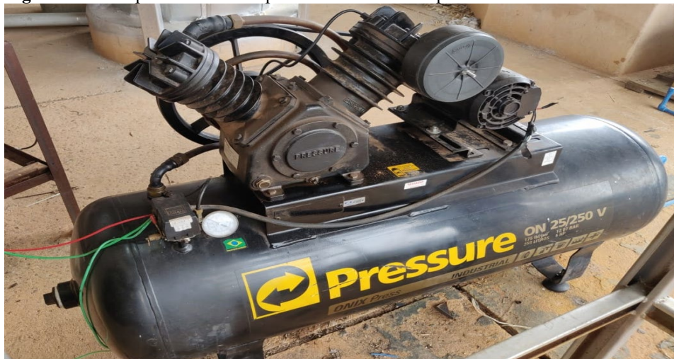
Figura 11 - Compressor utilizado para fornecer o ar comprimido ao tubo de vórtice
