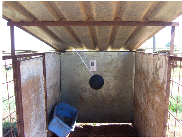
FIGURA 5 – Globo negro e termohigrômetro instalados no interior do abrigo.
