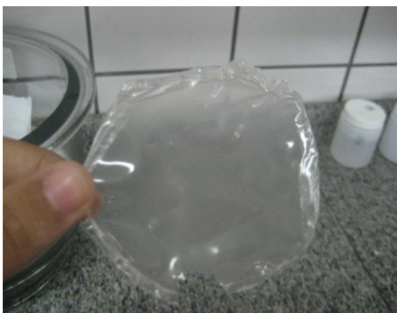
FIGURA 15. Foto de um Filme biodegradável à base de fécula de mangarito, água e glicerol.
