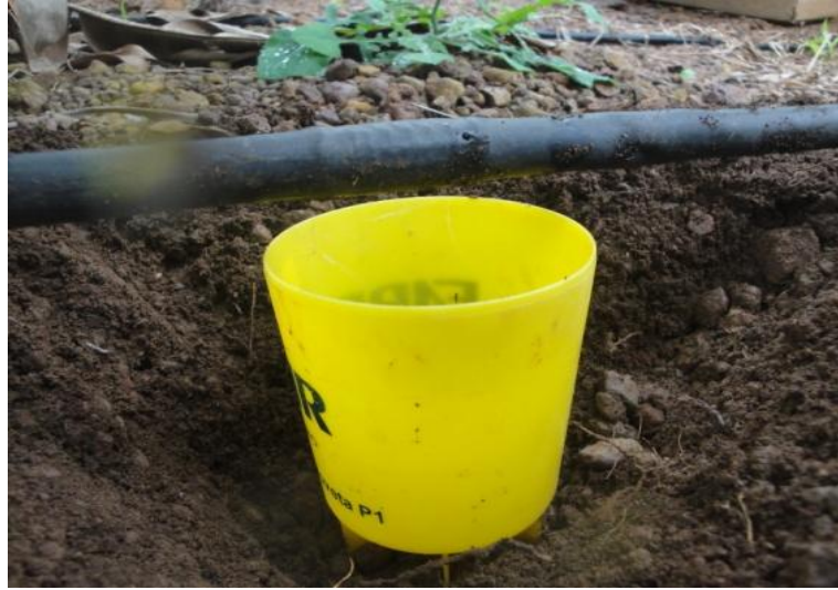
FIGURA 13. Ensaio de uniformidade de distribuição no sistema de gotejamento em campo.
