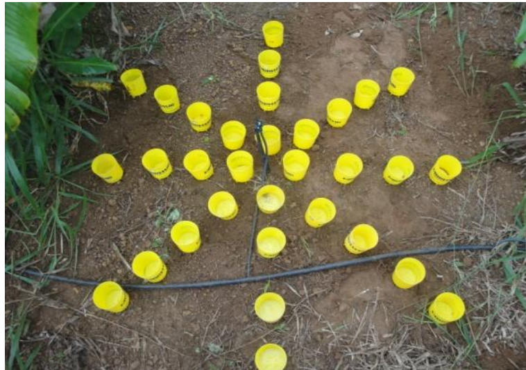
FIGURA 14. Ensaio de uniformidade de distribuição no sistema de microaspersão em campo.
