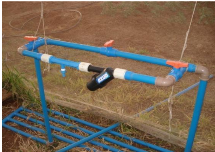
FIGURA 8. Cavalete para injeção de fertilizante, utilizando um Venturi.
