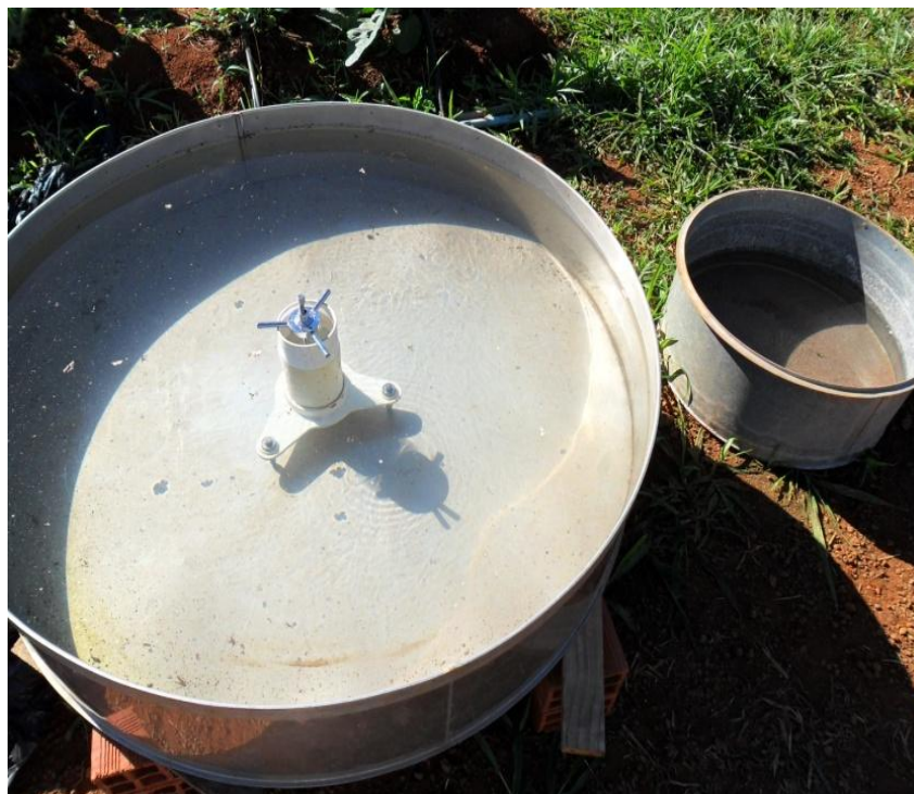
FIGURA 5. Tanque Classe A para determinação evapotranspiração de referência - ET_0
