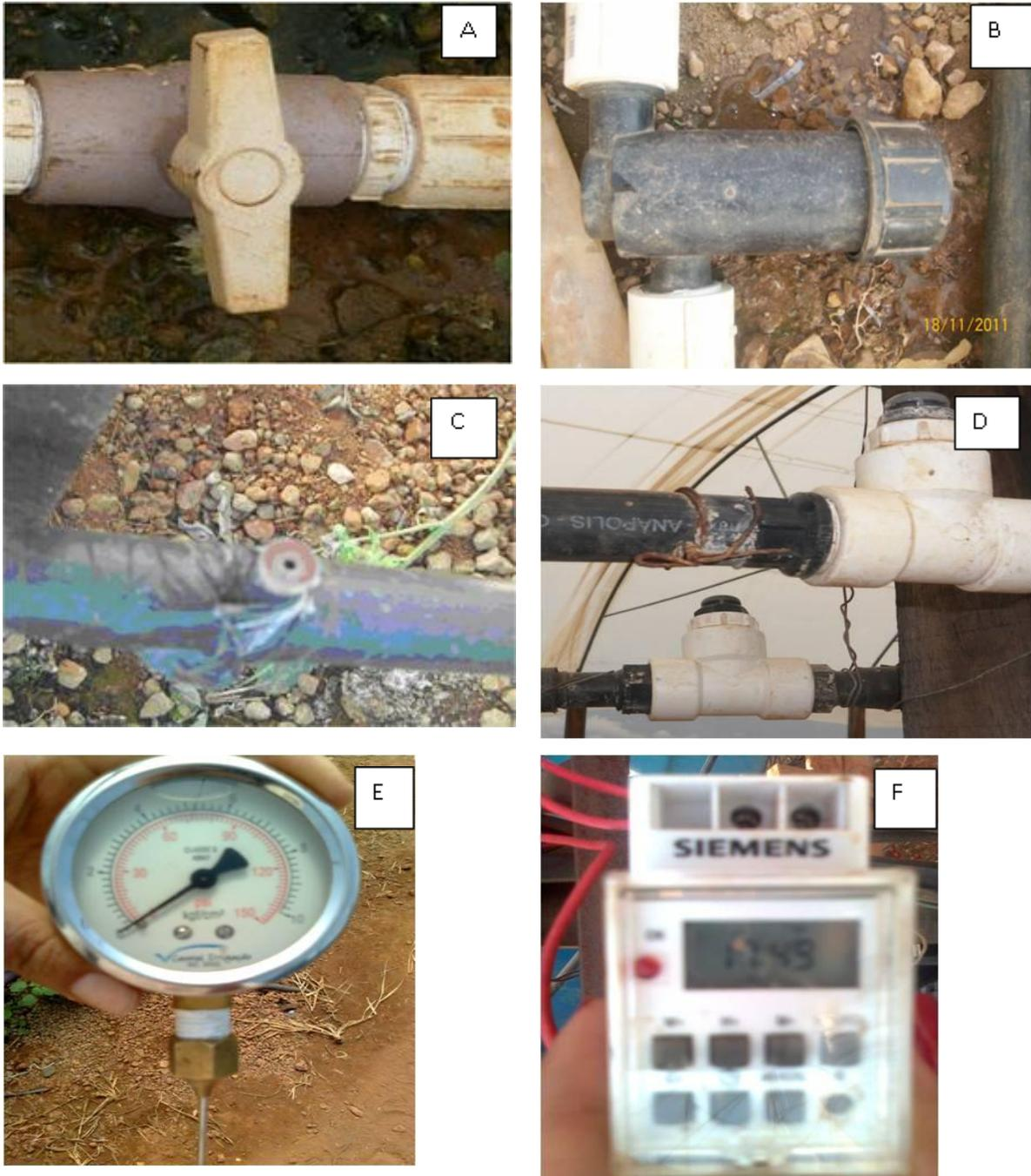
FIGURA 10. Equipamentos do sistema de irrigação: registro de esfera (A), filtro de disco (B), tomada de pressão (C), válvulas de alívio (D), manômetro de agulha (E) e timer (F).
