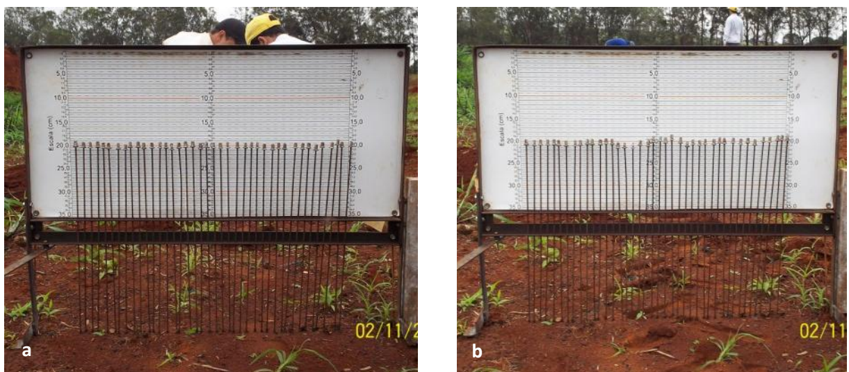
FIGURA 11. Medição do recalque do solo: a) perfil do solo antes do tráfego; e b) após o tráfego.
