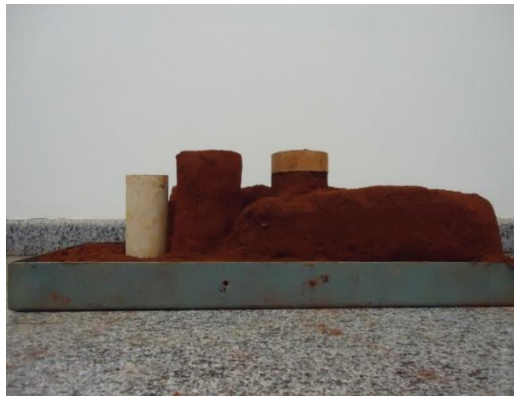
FIGURA 17. Processo de talhamento do bloco de solo para determinação da densidade do solo.
