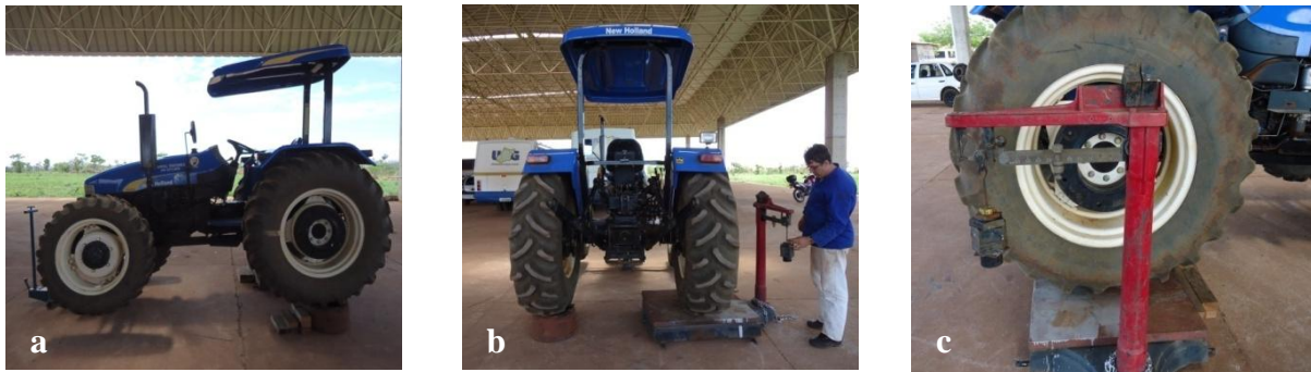
FIGURA 10. Determinação da força peso que age sobre a parte inferior do pneu traseiro do trator: a) nivelamento longitudinal; b) nivelamento transversal; e c) balança mecânica industrial.
