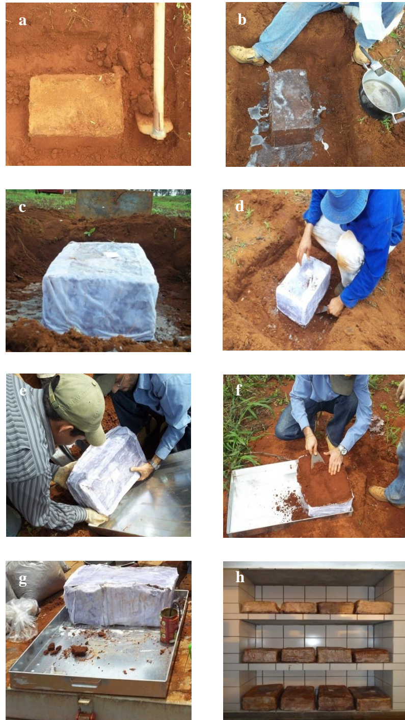
FIGURA 16. Retirada de amostras indeformadas: a) escavação do bloco de solo; b) adição da primeira camada de parafina; c) envolvimento da amostra com tecido de malha fina e uma nova camada de parafina; d) desprendimento do bloco; e) tombamento da amostra; f) regularização da parte inferior da amostra; g) adição de parafina e tecido na parte inferior da amostra; e h) acondicionamento em câmara úmida.
