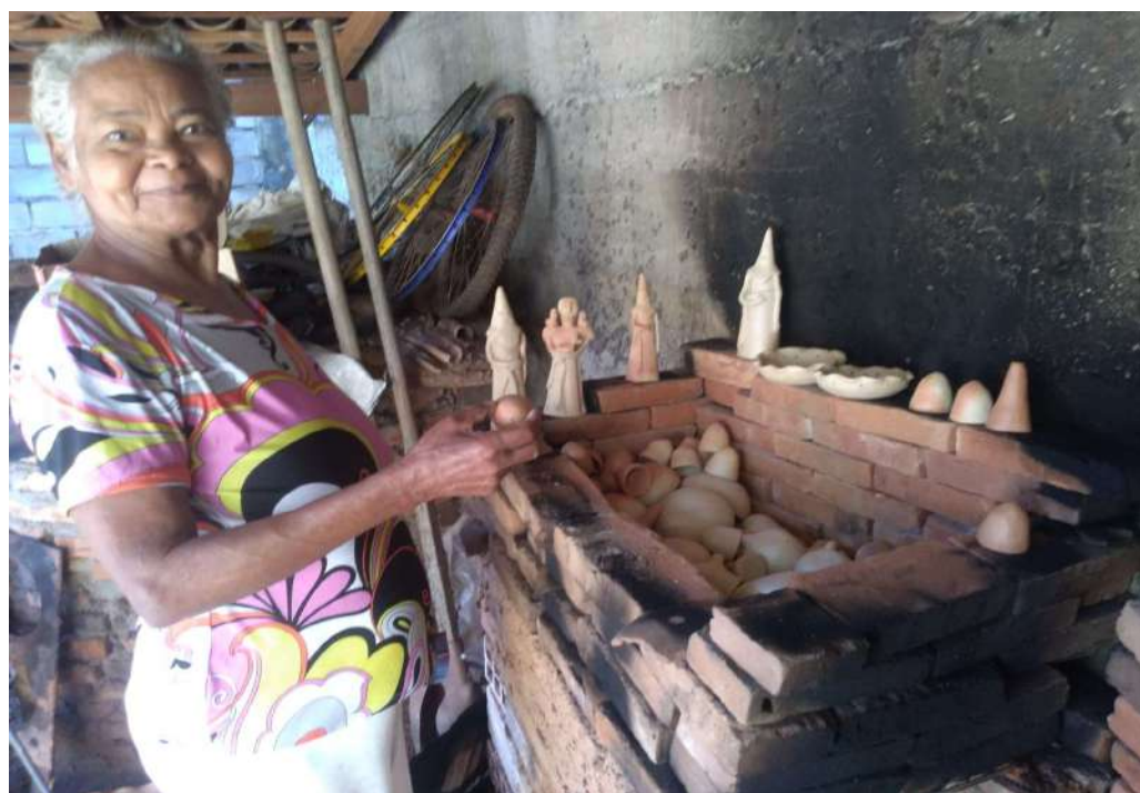
Figura 82: Forno à lenha de Dona Xica – Utilizado para queima das peças menores e em pequena quantidade – (Foto: Morgana)
