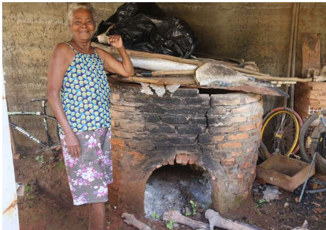
Figura 81: Forno à lenha de Dona Xica - Utilizado para queima das peças maiores e em grande quantidade – (Foto: Fernando Arkanjo)
