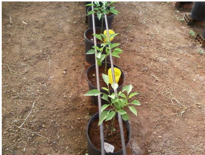
FIGURA 6. Copos coletores sob os gotejadores para análise da vazão do sistema de irrigação na casa de vegetação da UEG-UnUCET-Anápolis-GO.
