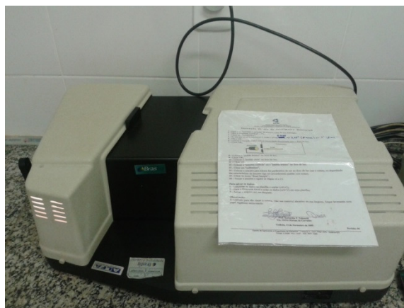
FIGURA 9 - Colorímetro ColorQuest XE, usado para indicar os índices de cor. Fonte: próprio autor.
