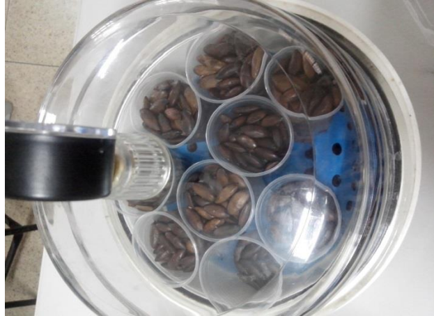
FIGURA 4- Amêndoas de baru armazenadas em dessecador. Fonte: Próprio autor.
