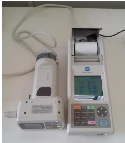
FIGURA 11- Colorímetro portátil CR-400 da Konica Minolta, usado para determinação dos parâmetros de cor. Fonte: Próprio autor.
