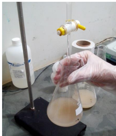
FIGURA 13- Titulação em solução padronizada de hidróxido de sódio. Fonte: Próprio autor.
