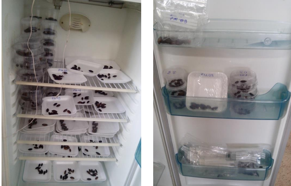
FIGURA 6- Amêndoas de baru in natura armazenadas em diferentes embalagens em B.O.D. a 10°C e 70±4% de umidade relativa. Fonte: Próprio autor.
