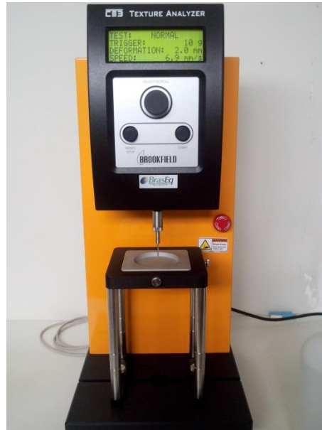
FIGURA 10- Texturômetro CT3 (Brookfield), utilizado para determinação de firmeza. Fonte: Próprio autor.
