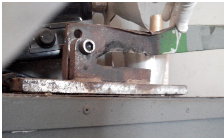
FIGURA 3- Protótipo de corte manual usado para quebra dos frutos de baru. Fonte: Próprio autor.
