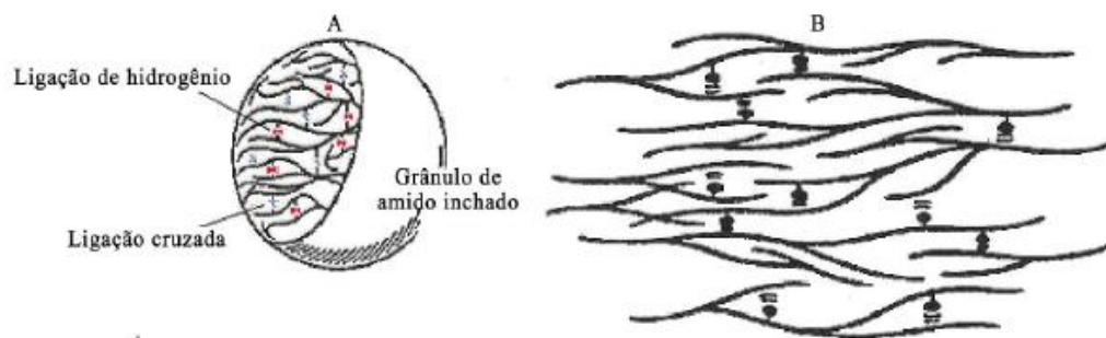
Figura 5 – Representação das ligações cruzadas no grânulo de amido e na estrutura (A): efeito sobre o grânulo de amido; (B) localização das ligações sobre o amido gelificado.
