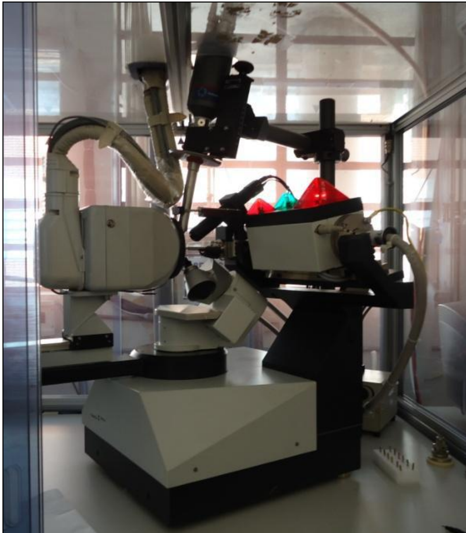
Figura 9. Ilustração do Difratorômetro Kappa - CCD, mostrando as possibilidades de movimento, cabeça do goniômetro com geometria kappa onde é montado o monocristal e detector de área CCD. (SALLUM, 2012).
