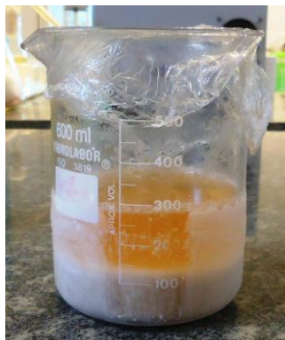
Figura 7: Extração do Pegico – 3ª fase (precipitação em álcool absoluto)
