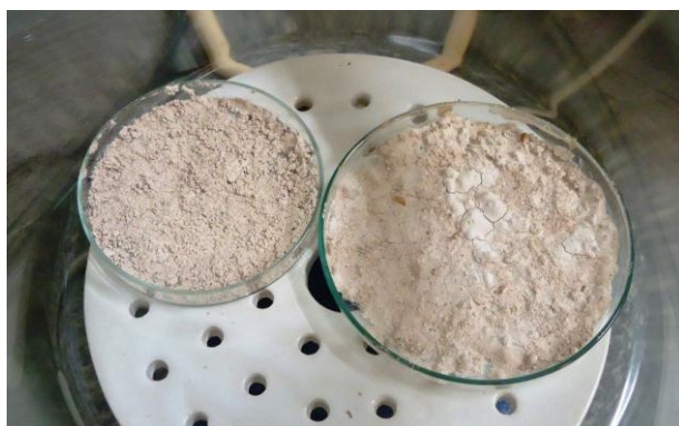
Figura 9: Extração do Pegico – 5ª fase (secagem em dessecador à vácuo)
