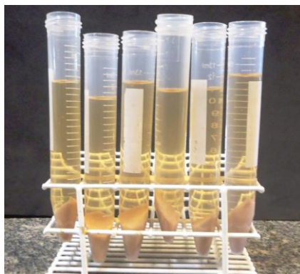
Figura 8: Extração do Pegico – 4ª fase (lavagem com álcool absoluto e centrifugação)
