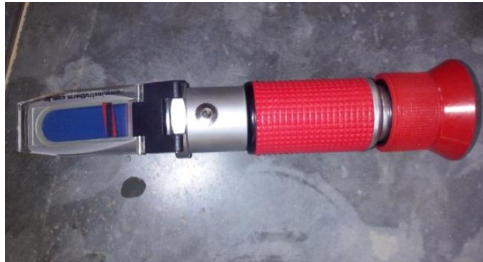
Figura 6: Refratômetro utilizado para medir o grau °Brix dos frutos. Ipameri, 2014. Foto: Rafael Benetti
