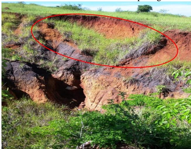
Figura 1 - Exemplo de movimento de massa em área de pastagem na Voçoroca do Barreiro
