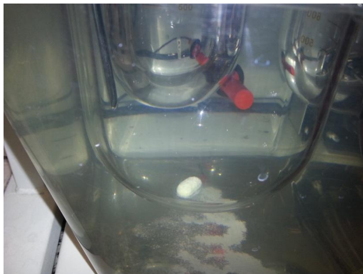
FIGURA 26. Demonstração do comprimido de NMS \beta -CD na cuba de dissolução.
