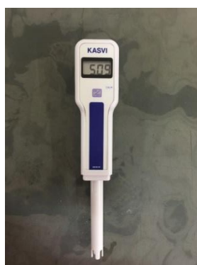
FIGURA 2. pHmetro KASVI, modelo K39-0014P, utilizado para determinar o pH das caldas.
