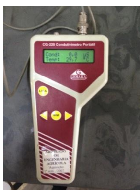
FIGURA 1. Condutivímetro Portátil, modelo CG-20 da marca GEHAKA, utilizado na determinação da condutividade elétrica.
