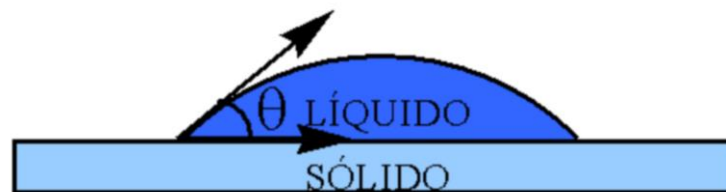
Figura 29 – Representação mostrando como o ângulo de contato de uma gota em uma superfície sólida é calculado.
