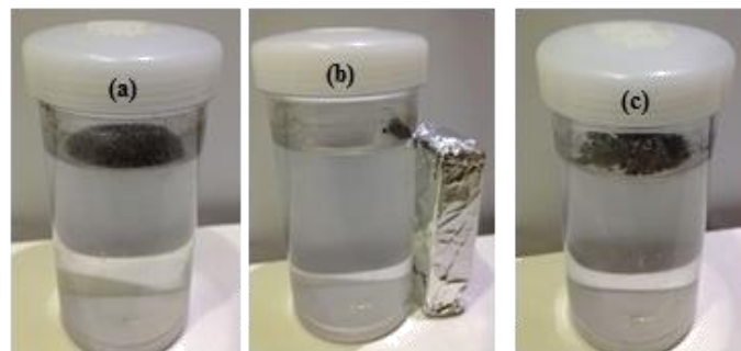
Figura 27 – Fotografias da amostra NP-GF11 em meio aquoso: (a) na ausência de um ímã, (b) após a aproximação de um ímã e (c) depois da remoção do ímã.
