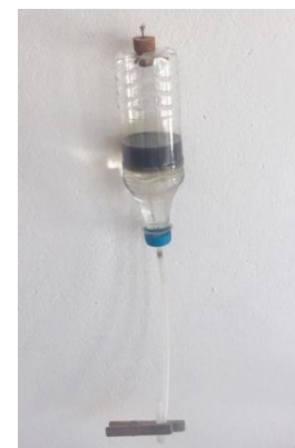
Figura 21 – Decantador alternativo de baixo custo.
