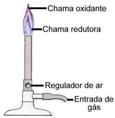
Figura 41– Esquema bico de Bunsen
