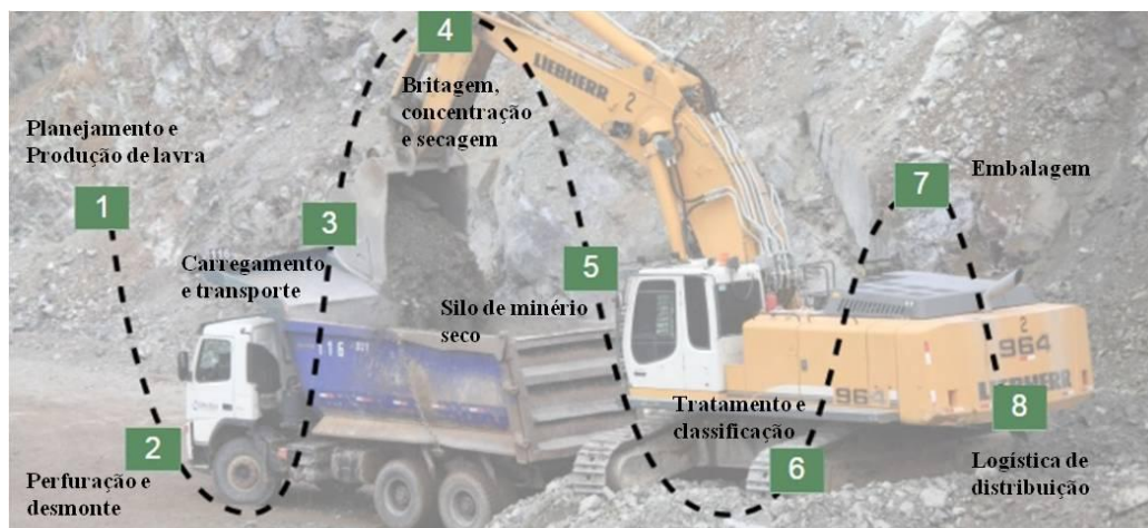
Figura 1. Etapas do processo de produção do amianto crisotila realizado pela SAMA. Fonte: SAMA MINERAÇÕES S.A. Disponível em: < http://www.sama.com.br/pt/crisotila/processo_de_producao/index.html > Adaptado.
