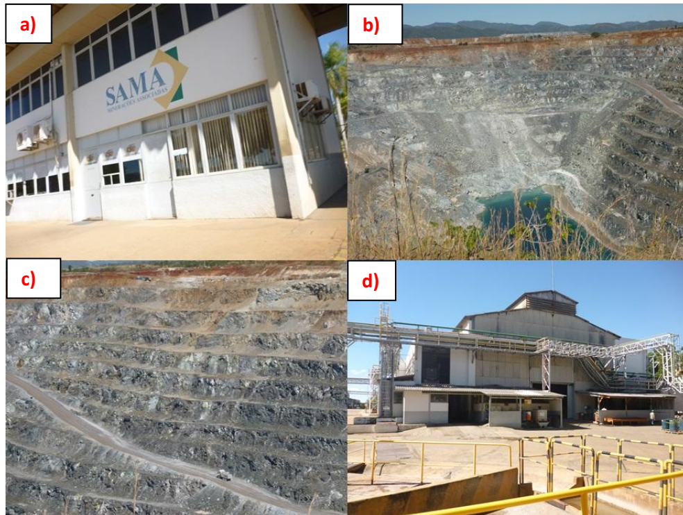
Figura 11. Fotografias realizadas na empresa Sama em Minaçu. a) Fachada da entrada da empresa. b) Cava A com a presença do lençol freático. c) Bancadas da Cava A e estrada de acesso à cava. d) Parte da planta de beneficiamento da empresa.
