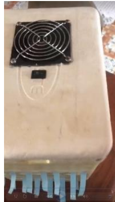
Figura 12 – Protótipos – Ar condicionado.
